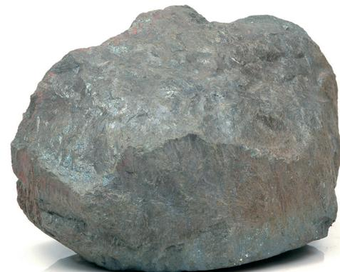
Erzeuger dieses Produktes ist die Aurubis AG in Hamburg. Hier wird beim Schmelzen von Kupfererzkonzentraten, die auch ca. 30% Eisen in chemisch gebundener Form enthalten, unter Zugabe von Quarzsand bei einer Temperatur von ca. 1.250° C pyrometallurgisch eine Eisensilikatschmelze erzeugt.
