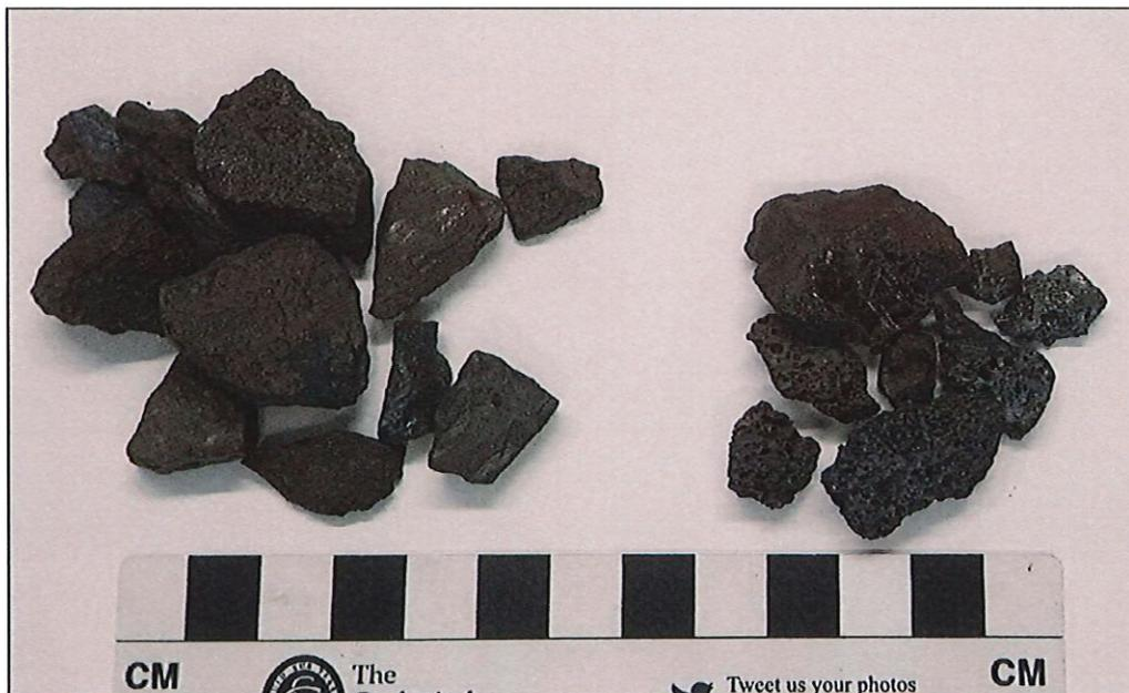
**Bild 2:** Beispielhafte Partikel der Fraktionen der dichten der (links) und der porösen Bestandteile (rechts).
